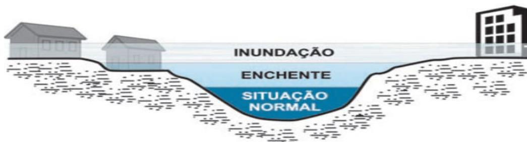
**Figura 02:** Perfil esquemático do processo de enchente e inundação.
