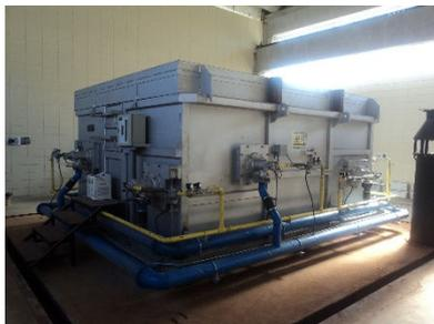
Figura 3 – Forno horizontal para ensaios de estruturas a altas temperaturas, no campus da USP - São Carlos, Brasil.
