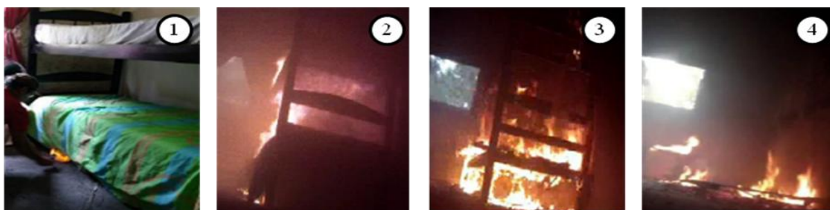
Figura 1 - Fases de um incêndio vistas por meio de estudo experimental no CBMPE.
