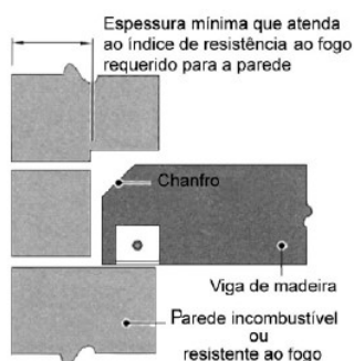
Uso de piso elevado de madeira
